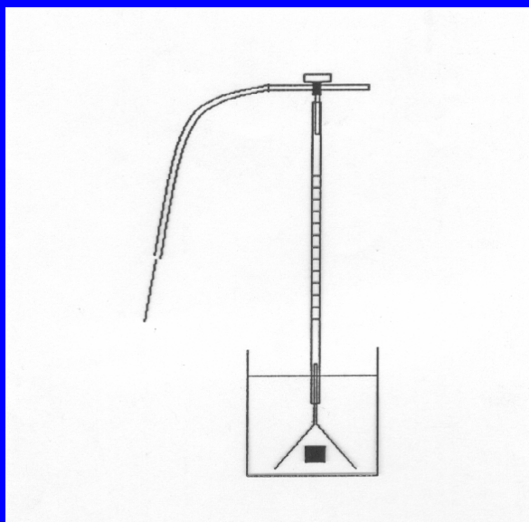
Volumetrijsko mjerenje količine razvijenog vodika
