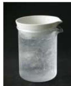
Slika 13. Aparatura za hlađenje otopine u ledenoj kupelji.
