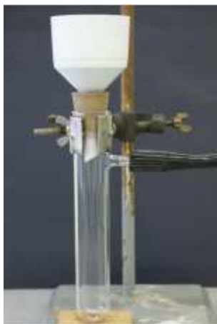
Slika 15. Aparatura za filtriranje uz sniženi tlak
