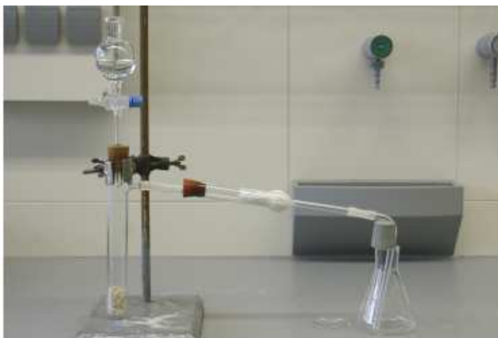
Slika 19. Aparatura za dobivanje ugljikova(IV) oksida.
